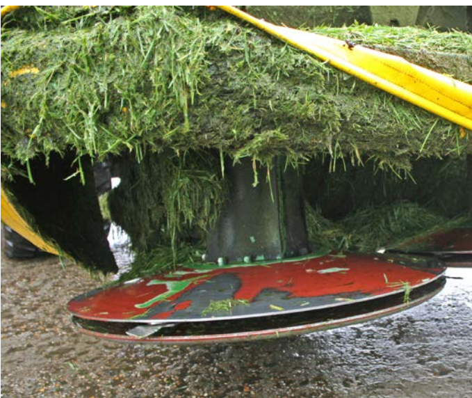
Græsset skæres af med en tromleskårlægger. Foto: Mads Blenker.
